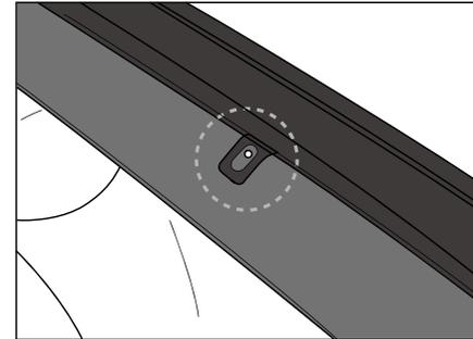
⑥ 再びドアバイザーの穴の位置と取り付けした金具の位置を確認します。もし金具の位置がずれていた場合、金具を無理やり動かすと車体を傷つける恐れがありますので、一度取り外しから正しい位置に取り付けてください。
