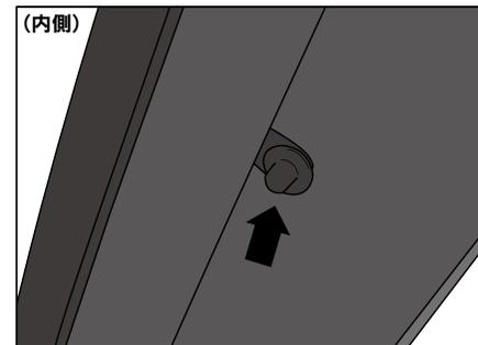
⑩ ドアバイザーと金具を間に挟んで、ピンの反対側にキャップを取り付けて固定します。
