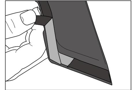
⑦ 金具を取り付けたらドアバイザーを貼り付けていきます。裏側に付いている両面テープを少しはがして車体に仮止めをします。
