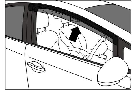
③ フロント、リアともに、ドアと、ドアバイザーの形に合わせて取り付け位置を決めて、ドアバイザーの穴の位置から金具を取り付ける位置を確認します。
